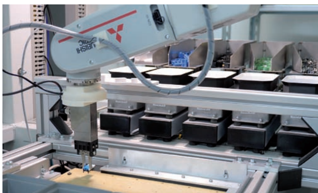
V minulosti realizovali osadzovanie väčších súčiastok na dosku plošných spojov štyria pracovníci, ktorých výkon zvládol nahradiť jeden priemyselný robot.
