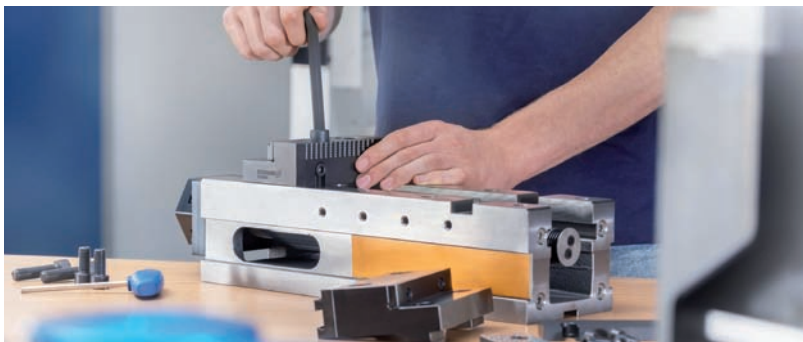
Adaptérové čeluste SCHUNK vytvárajú premostenie medzi zverákmi od iných výrobcov a rozsiahlym portfóliom vrchných čelustí od spoločností SCHUNK/GRESSEL. (Foto: SCHUNK)
