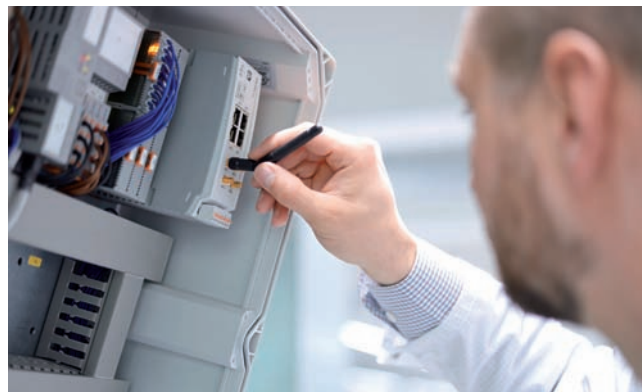
Obr. 4 Smerovač 5004T-5G EU TC je ideálny na použitie v priemyselných aplikáciách 5G; možno ho priestorovo úsporne namontovať do rozvádzača, pričom všetky rozhrania sú umiestnené na prednej strane zariadenia.
