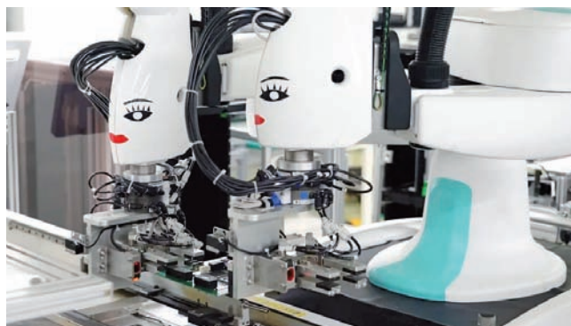
V kombinácii s jednoúčelovým strojom na spájkovanie je duAro zodpovedné za prácu od dodávania obrobkov až po ich vyberanie. Skutočnosť, že robot má na ruke nakreslenú „tvár“, ukazuje, že duAro je medzi zamestnancami obľúbený.
