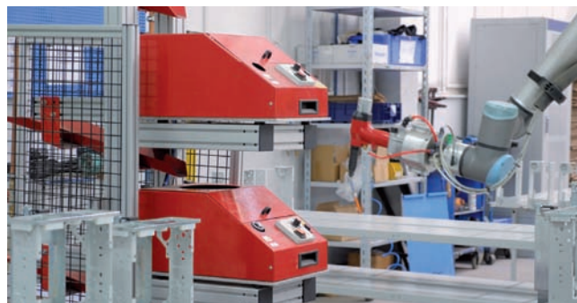
Pracovisko nitovania telekomunikačných stojanov s kolaboratívnym robotom
