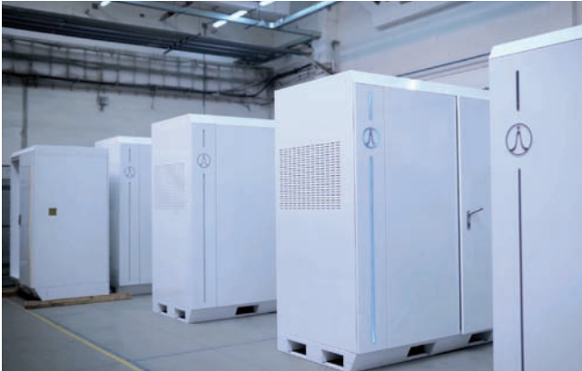
TESLA Liptovský Hrádok, a. s., začala s výrobou batériových úložísk od nízkokapacitných až po veľkokapacitné inštalácie v rozmedzí od 60 kWh do viac ako 1,5 MWh.
