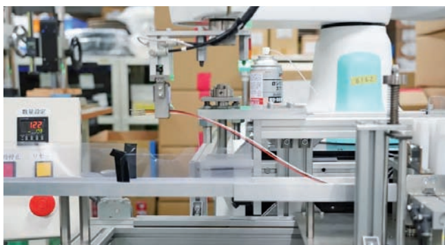
Práca na prechode viacerých tenkých elektrických drôtov s priemerom približne 1,4 mm cez flexibilnú trubicu bola úspešne automatizovaná pomocou prvkov a rúk robota.
