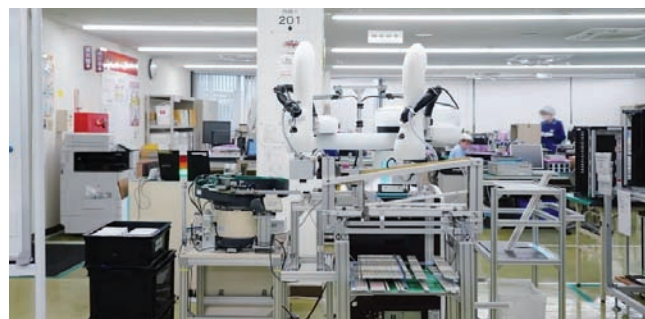
14 typov konektorov je zoskupených v držiakoch a odoslaných do následného procesu montáže. To je kombinované s riadiacim systémom, ktorý súčasne riadi periférne zariadenia okolo robota, napr. dopravník privádzajúci medziprodukty, motory a snímače.
